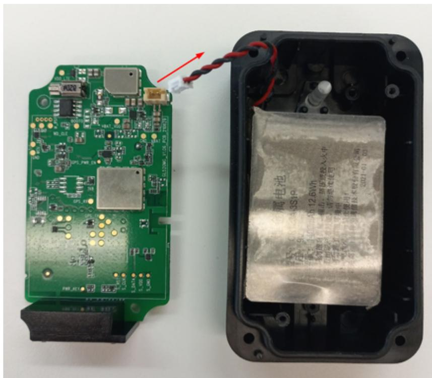
5. **Retire la batería agotada.** Está fijada con adhesivo y necesitará aplicar fuerza hacia arriba para despegarla del estuche.
