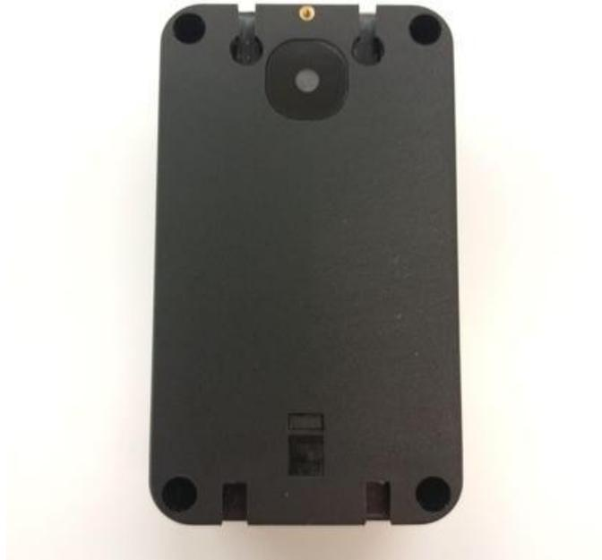
2. De la vuelta a la unidad y retira la tapa superior. Ubica y retira los dos tornillos de cabeza Phillips cerca de las esquinas de la placa.
