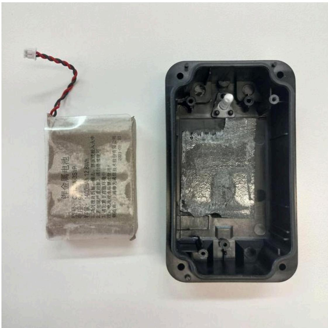
6. **Inserta la batería nueva en la misma orientación (consulta la foto de [Alineación de la Batería para asegurarse](#)).**
