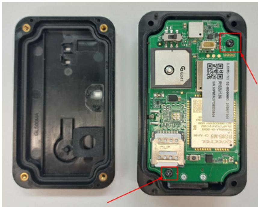
3. Te recomendamos mover el interruptor de la batería a la posición de apagado. Por favor, recuerde encenderlo antes de volver a utilizar el dispositivo.
